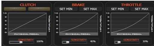
**SENSIVITY:** Los tres parametros funcionan igual, y tienen este efecto sobre los pedales: 100% totalmente regular, menos de 100% menos intensidad al principio, más de 100% mas intensidad al principio del recorrido del pedal.
